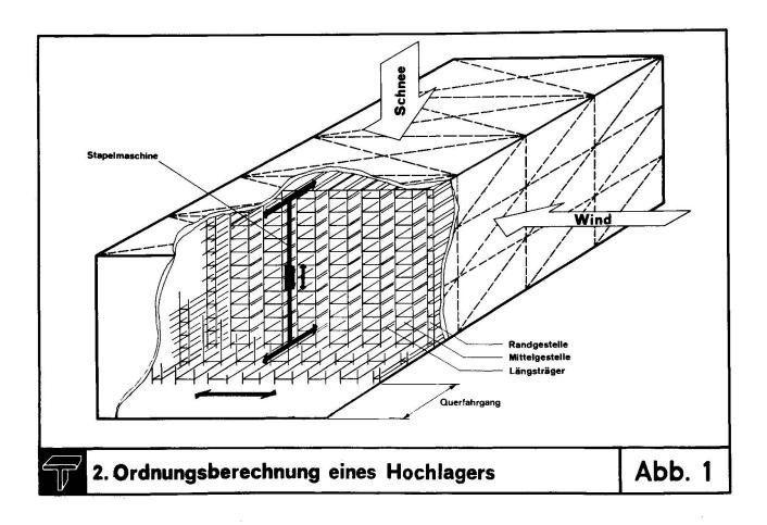
keit der Stahlkonstruktion durch konstruktive Ueberlegungen beeinflusst werden kann. Die Konstruktion setzt sich aus wenigen, aber in grosser Zahl vorkommenden Bauteilen zusammen, im wesentlichen aus den Randgestellen, den Mittelgestellen und den verbindenden Längsträgern. Die vollautomatisch ausgeführten Bewegungen der Stapelmaschine bedingen nicht nur eine sehr hohe Präzision in der
