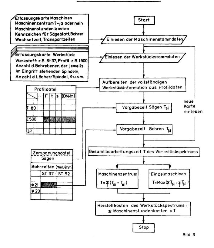
Ähnlich wie im beschriebenen Beispiel läßt sich mit Hilfe des Erfassungssystems auch feststellen, ob die Engpässe der Fertigung beim Sägen oder Bohren liegen, ob überhaupt alle Werkstücke des Spektrums auf der Fertigungslinie gefertigt werden können, ob die Anlagen in ihrer Leistungsfähigkeit und in der Vielfalt ihrer technischen Variationsmöglichkeiten sinnvoll genutzt sind und vieles mehr.
