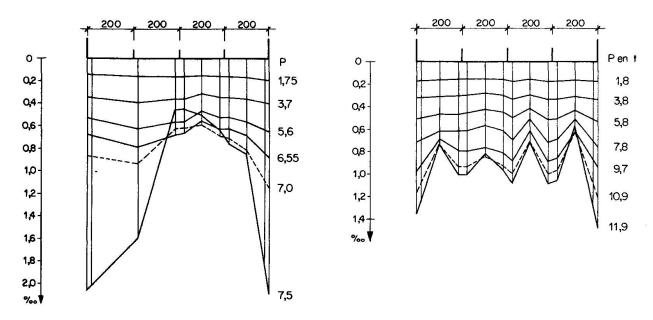
Répartition des allongements dans la section médiane du panneau comprimé (feuillet moyen), pour div. valeurs des charges appliquées fig. 9a Poutre A2 fig. 9b Poutre Al
