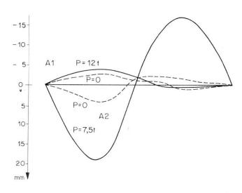
fig. 6 Déformations le long du raidisseur central
