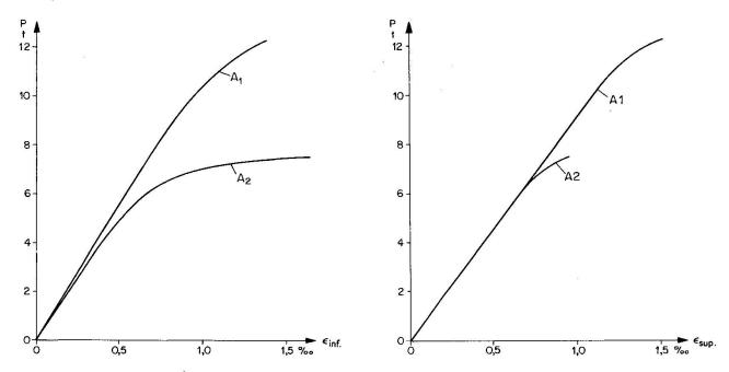
Progression des allongements dans la section de P fig. 8a Semelle comprimée fig. 8b Semelle tendue
