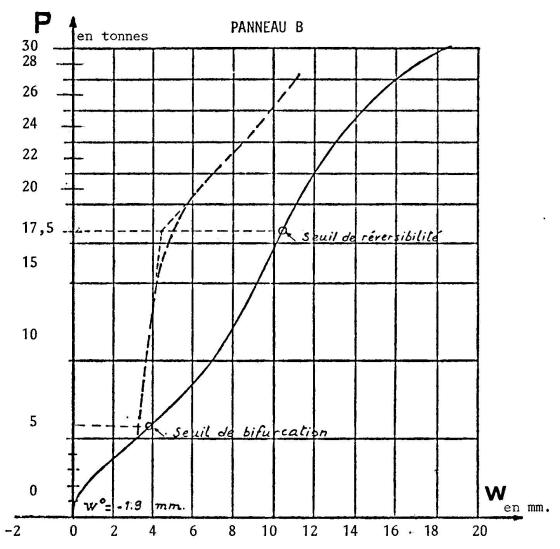
Fig. 9 - DEPLACEMENT D'UN POINT DE L'AME HORS DU PLAN MOYEN DU PANNEAU B ( en mm. )
