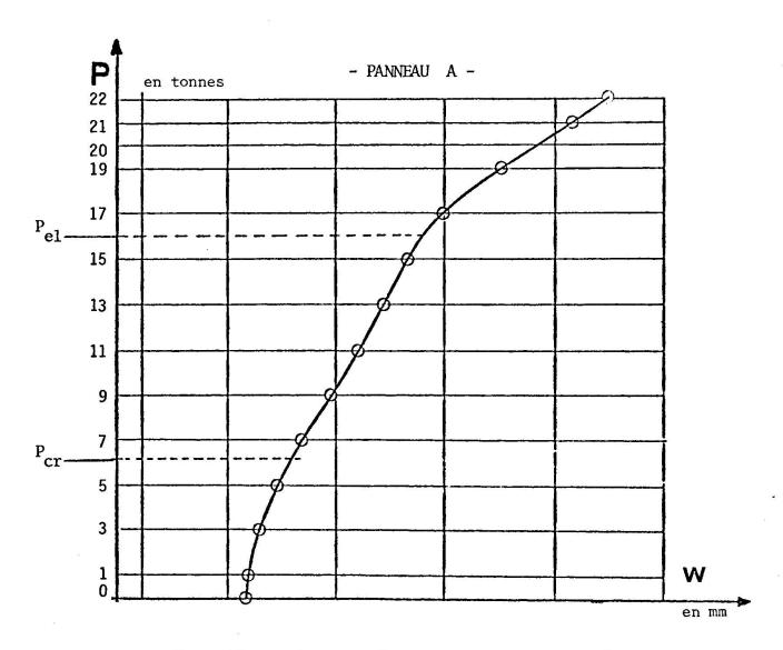
W: déformation hors du plan moyen, au centre du panneau  $P_{cr}$  = 6,22 tonnes  $P_{el}$  = 16 tonnes
