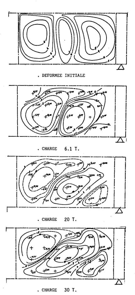
Fig. 7 - DEFORMEE DE L'AME HORS DU PLAN MOYEN DU PANNEAU B (en mm)
