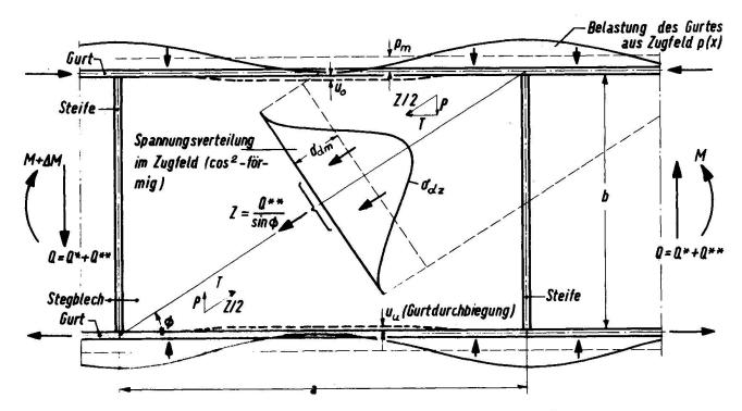
Bild 11: Gedankenmodell zur Spannungsverteilung im Zugfeld und resultierende Gurtbelastung
