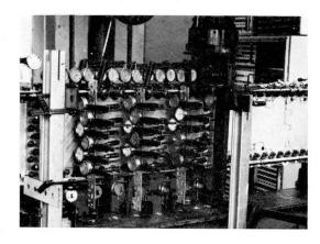
Bild 2: Meβeinrichtung für Stegverformungen
