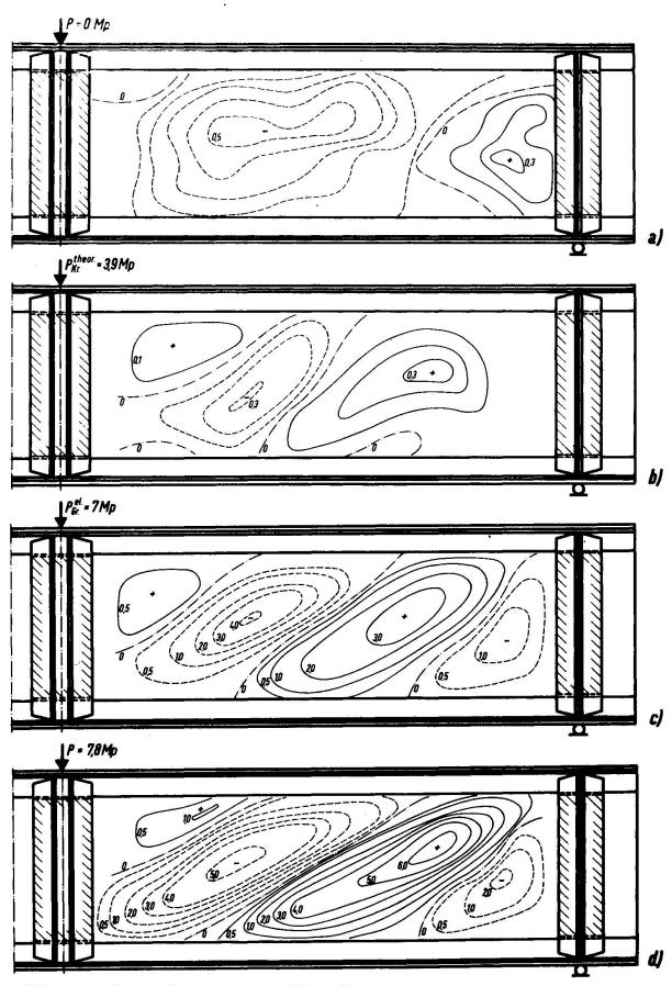
Bild Ba÷d: Stegverformungen von Träger 5
