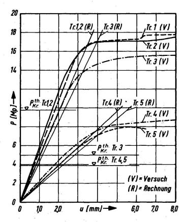
Bild 4: Last-Durchbiegungskurven der Träger (Tr) 1 bis 5
