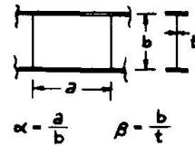
Erforderliche Gesamtquerschnittsfläche eines Quersteifenpaars:
