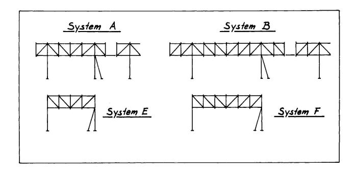
Bild 6 Neue Systeme standardisierter Rohrbrücken Nennlast 2,0 ....6,0 Mp/m
