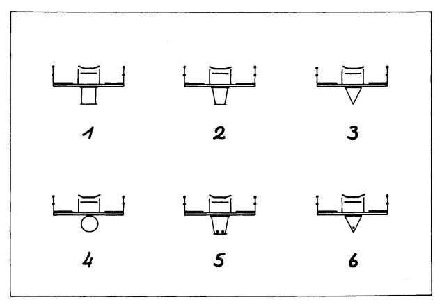
Untersuchte Varianten von Hauptträgerquerschnitten
