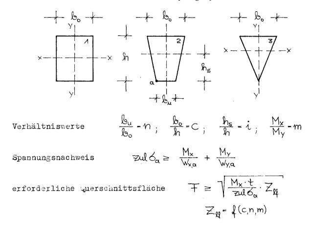
Bild 2 Variantenuntersuchung von Hauptträgerquerschnitten offener Bandbrücken
