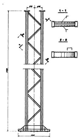
Bild 7. Ausbildung der Hallenstützen aus Kaltprofilen.
