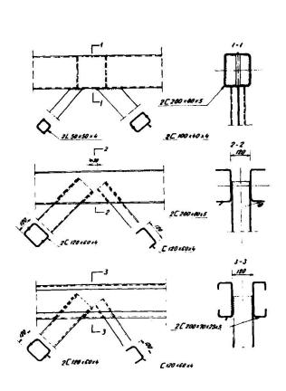
Bild 6. Stabanschlüsse der Fachwerkbinder aus Kaltprofilen.
