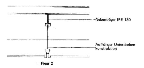
Für die unveränderliche Anordnung der Hauptträger ( siehe Figur 3 ) werden die Lösungen 1 und 2 der Nebenträger ( Figur 1 und 2 ) verglichen.
