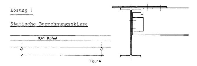
Träger wird auf mehr Stützen fortgeführt (Durchlaufende)
