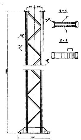
Bild 7. Ausbildung der Hallenstützen aus Kaltprofilen.
