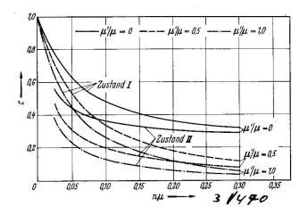
Fig. 2 Steifigkeitsbeivert
