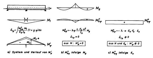
Fig. 4 Zwängung M, am Durchlaufträger
