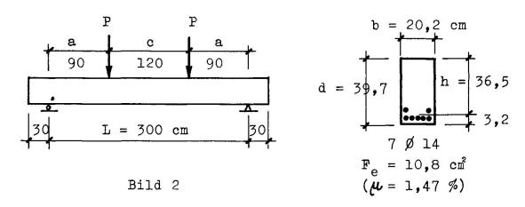
Für den Versuchsbalken Nr. A2a von FRANZ und BRENKER /1/ (Bild 2) mit den gemessenen Werten für die
