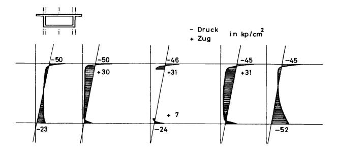
Bild 2 Temperaturspannungen in Folge einer Erwärmung nach Bild 1 an frei verformbarem Stab, bei Annahme E=400'000kp/cm
