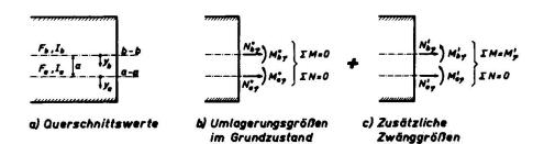
Fig. 3 Umlagerungsgrößen beim Durchlaufträger
