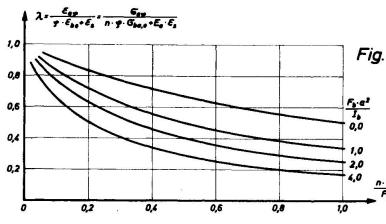
Fig.2 Umlagerungskennwert λ in Abhängigkeit von der Bewehrungsanordnung ( $I_a$ =0)
