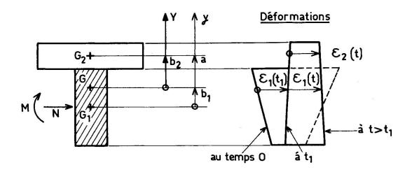
Figure 7 - (en pointillé : déformation du béton  $B_1$  à  $t > t_1$ , en l'absence du béton  $B_2$ ).
