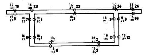
Bild l Zwei nacheinander folgende Temperaturmessungen und die Differenzen in <sup>O</sup>C an einem Brückenquerschnitt
