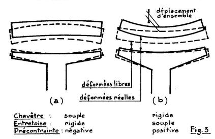
Les déformabilités des pièces en contact correspondent, respectivement, aux cas a et b de la Fig. 3.
