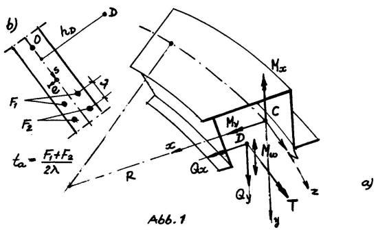
Die Achse x und die Stabachse (Abb.la) mit dem Balbmesser R, welche die Punkte C der Stabquerschnitte verbindet, liegen in einer Ebene. Die längs der Stabachse gemessene Bogenlänge von einem vorherangenommenen Querschnitt aus ist durch die Koordinate x bestimmt.
