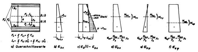
Fig.1 Verformungen und Spannungen im Querschnitt
