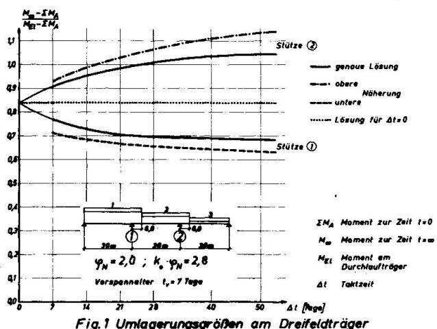
Fig. 1 Umlagerungsgrößen am Dreifeldträger
