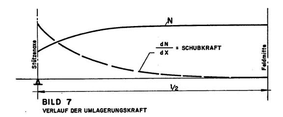
Im Bild 7 ist der Verlauf der endgültigen Umlagerungskraft N für das Innenfeld eines Durchlaufträgers mit unendlich vielen Spannweiten dargestellt. Die erste Ableitung der Umlagerungskraft dN ergibt die Verdübelungsbeanspruchung der Fuge zwischen dx
