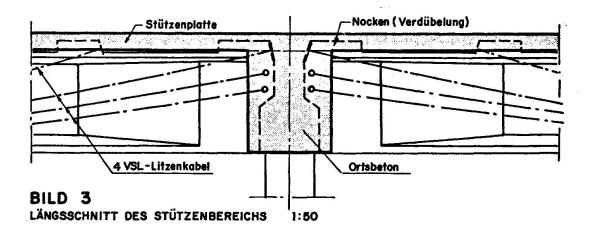
Die 2 Platten im Stützenschnitt erhalten zudem vor der Verlegung eine zugbandartige Vorspannung in Brückenlängsrichtung. Die Fahrbahnplatte ist in Querrichtung nicht vorgespannt.
