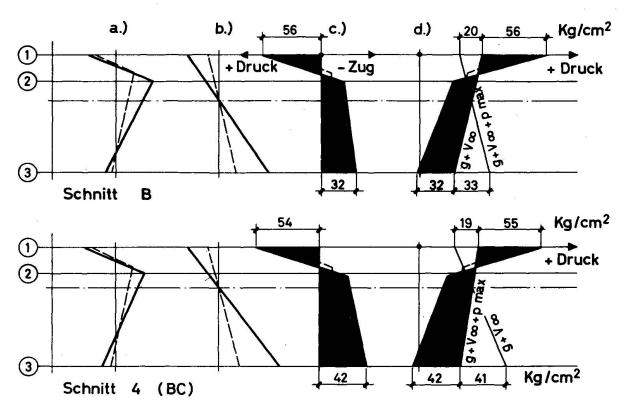
Bild 6 a) Eigenspannungen 1. Art
