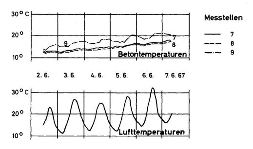
Bild 9 Beton- und Lufttemperaturen im Juni 1967. Brücke mit Schotterbett
