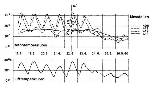
Bild 3 Beton- und Lufttemperaturen Juni 1960
