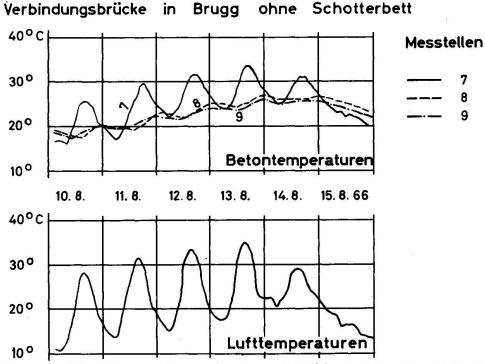
Bild 8 Beton- und Lufttemperaturen im August 1966. Brücke ohne Schotterbett
