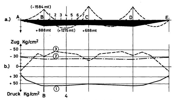
Bild 5 a) Zwängungsmomente am durchlaufenden Balken
