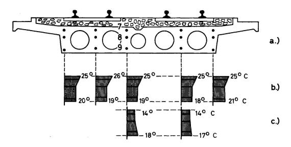
Bild 7 Verteilung der Temperatur im Betonquerschnitt
