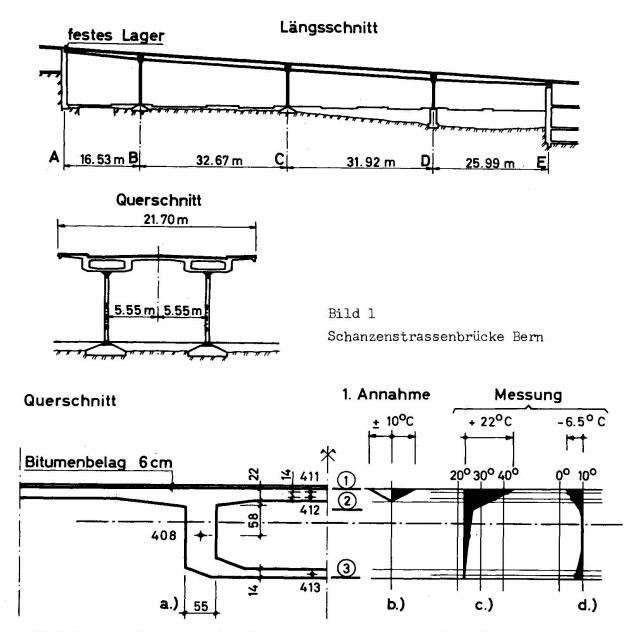
Bild 2 a Anordnung der Temperaturmessgeber 411, 412, 408, 413 b Angenommene Temperaturdifferenz für stat. Berechnung c Gemessene Temperaturverteilung am 22. Juni 1960 (Bild 3) d Gemessene Temperaturdifferenz am 13. April 1960 (Bild 4)
