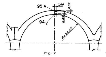
Au cours du premier remplissage sont apparus sur certains témoins sonores des allongements très importants, sans fissuration du béton. Une étude a été entreprise afin d'en trouver une explication. Nous donnons ici les résultats de l'analyse faite sur les triangles d'extensomètres 95 M (amont) et 94 V (aval), situés en clé de la voûte 3-4, au niveau 760 . (fig. 2)
