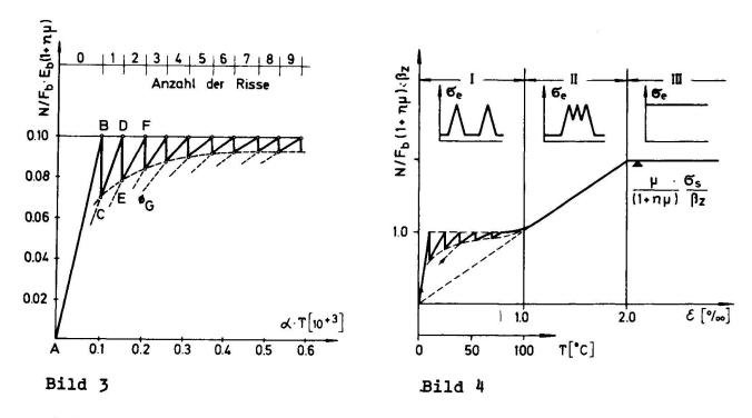
In [1] ist die Auswertung (2.12) an einem Beispiel gezeigt (Bild 3). Mit fallender Temperatur steigt die Normalkraft bei Erstbeanspruchung zunächst von A nach B an, fällt beim Entstehen des ersten Risses nach C ab, steigt wieder bis D anusw.
