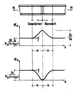
wobei  $\Delta N(\zeta)$  die durch den Verbund zwischen Beton und Stahl übertragene Kraft je Längeneinheit bedeutet.
