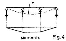
c - De même, le fluage différentiel entre  $B_1$  et  $B_2$  (§ II.3) donnerait, en chaque section, la courbure :  $(A-\lambda)\frac{1}{L_A} + \lambda \frac{1}{L_A}$ , où:  $\frac{1}{L_A} = \frac{M}{EI}$  désigne la courbure de la poutre préfabriquée, si elle était restée isolée, et  $\frac{1}{L_A} = \frac{M-Nb_1}{EI}$ , celle de la section totale  $(B_1 + B_2)$  si elle avait été réalisée d'emblée dans sa totalité.
