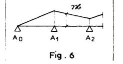
égales à celles des moments que développeraient, dans les mêmes sections de la poutre continue définitive les charges fictives :  $q^* = q \cdot \Psi(t_3 - t_4)$ , où q désigne les charges réellement appliquées avant le temps  $t_3$ .
