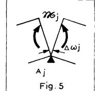
Si la structure avait été réalisée d'emblée (au temps  $t_1$ ) sous sa forme continue définitive, elle aurait été soumise, sous l'action des charges  $\underline{q}$  réellement appliquées avant  $t_3$  (poids propre et précontrainte  $P_1$ ) aux moments  $\underline{M_j}^*$  dans les sections  $A_j$ .
