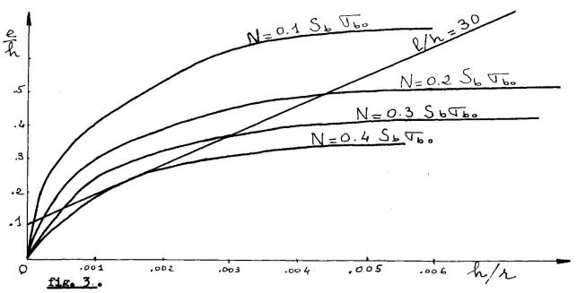
L'exemple choisi sur la figure 3 est celui d'un élancement géomètrique 1/h = 30 et d'une excentricité initiale  $e_0 = 0.1 h$ .
