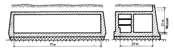
Bild 3 Maschinenhaus des Pumpspeicherwerkes Glems b. Stuttgart
