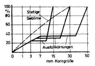
Bild 1. Ausfallkörnung zur Reduktion der nötigen Zementmenge
