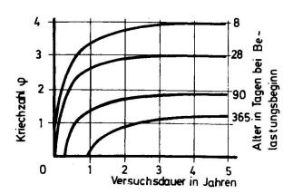
hat, bevor er den Einflüssen ausgesetzt wird, die Kriechen und Schwinden auslösen (Bild 2). Der Reifeprozeß erfordert Zeit und Wärme, die erforderliche Zeit kann durch höhere Temperatur abgekürzt werden (Dampfhärtung). In gemäßigtem
