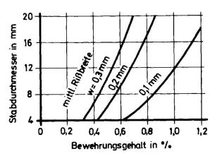
Bild 6. Erforderl. Bewehrungsgehalt zur Beschränkung der Rißbreite auf w bei mittigem Zwang für gerippten Betonstahl mit  $\beta_S \le 40 \text{ kp/mm}^2$  (nach H. Falkner [7])
