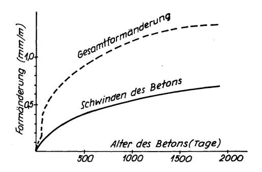
Abb.9 Schwinden und Kriechen der Betonprismen
