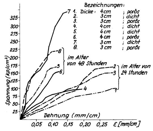
Abb.6 Spannungs-Dehnungs Linie des Fugenmörtels
