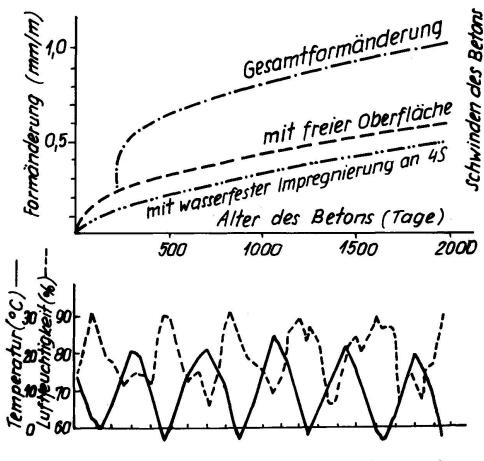
Abb.4 Schwinden und Kriechen der Betonprismen
