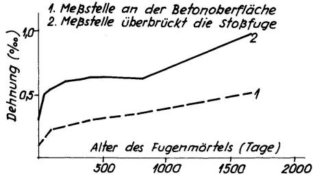
Abb.5 Formänderung der mit einer Dauerbelastung von 70 kp/cm<sup>2</sup> beanspruchten Faser in Querschnitt III.
