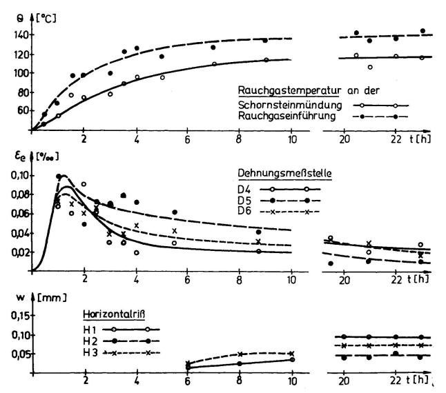
Beanspruchung eines Stahlbetonschornsteinmantels mit Bild 1: d = 150 mm und  $\mu_z$  = 0,5 % bei erstmaliger Aufheizung
