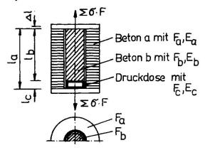
Im Lastfall  $\triangle l$ =const. wird zum Zeitpunkt  $t_1$  mit der Kriechzahl  $\varphi_1$   $U_1 = \frac{\sigma_{a,1}}{\sigma_{c,1}} = \frac{1}{\alpha} \cdot \frac{l_b E_a F_c}{l_a E_b F_b} \cdot e^{\varphi_1(\alpha - 1)}$ mit  $\alpha = \frac{l_b E_c F_c}{l_b E_c F_c + l_c E_b F_b}$
