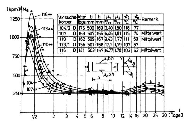
Bild 3: Einspannmomente M einer zweiseitig verdrehungsbehindert gelagerten Stahlbetonplatte bei erstmaliger Aufheizung in Abhängigkeit von der Zeit t und dem Bewehrungsgrad (Zugbewehrung), Aufheizgeschwindigkeit 20 grd/h.
