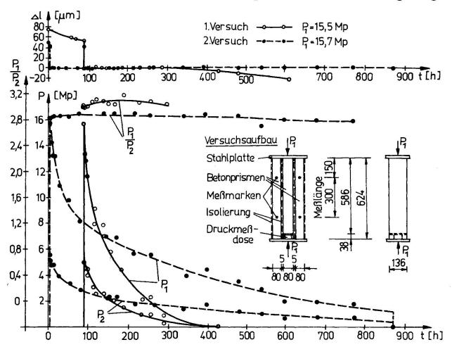
Bild 7: Relaxationsmessungen mit Druckmeßdose; Laborversuch bei 30°C; F, und P, Querschnittsfläche bzw. Kraft in allen drei Betonprismen; F<sub>2</sub> und P<sub>2</sub> entsprechend im mittleren Betonprisma allein.
