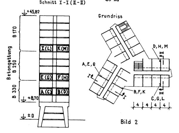
Das tragende System bilden unbewehrte, 15 cm dicke Querwände in Verbund mit den Gang-Längswänden und durchlaufende, 12 cm dicke, Ortbeton-Stahlbeton-Deckenplatten. Die Betongüte ändert sich mit der Gebäudehöhe, in den unteren Geschossen ist der Beton der Würfelfestigkeit 330 Kp/cm2, in den mittleren Geschossen 250 Kp/cm2, in den oberen Geschossen 170 Kp/cm2. Die Decken sind aus Beton der Würfelfestigkeit 250 Kp/cm2.
