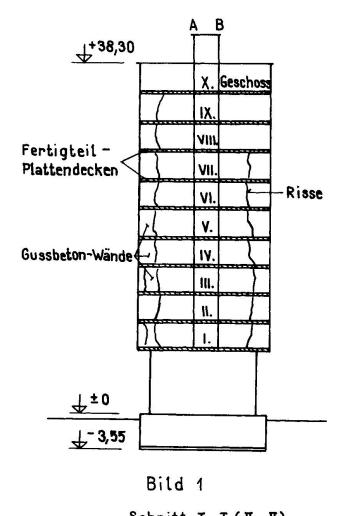
Dies bezweckte, dass langfristige Volumenveränderungen im Beton, in gegenseitig benachbarten Konstruktionsteilen womöglich gleich verlaufen. Ebenfalls wurde vereinbart, dass an ausgesuchten Konstruktionsstellen, die Beton-Verformungen langfristig beobachtet werden.
