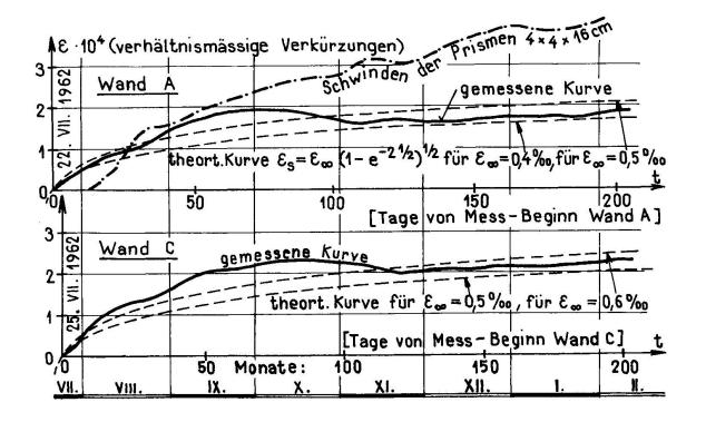
An der Wand A entspricht die gemessene Wertgrösse des Beton-Schwindens für den beobachteten Zeitraum dem theore - tischen Verlauf mit  $\varepsilon_{\infty} \doteq 0,415$ , an der Wand C mit  $\varepsilon_{\infty} \doteq 0,54$ .
