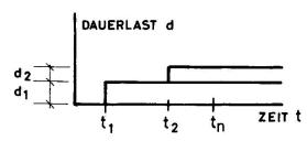
Bild 4: Einzuhaltende Art der Superposition bei den nach [4] angesetzten Kriechbeiwerten
