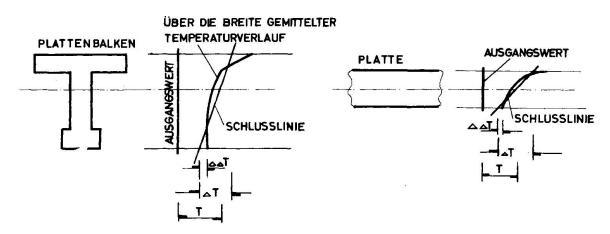
Bild 3: Beispiele für die Aufschlüsselung der Temperaturverteilung bei verschiedenen Querschnittsformen
