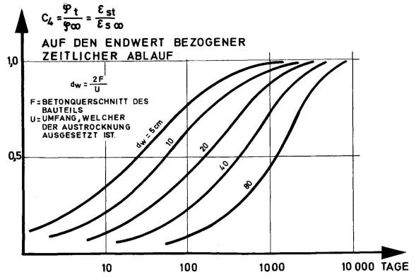
Bild 14: Zeitlicher Ablauf von Kriechen und Schwinden
