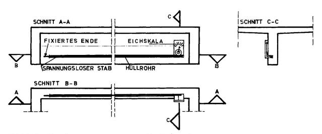
Bild 2: Verformungsmessung mit Meßstab
