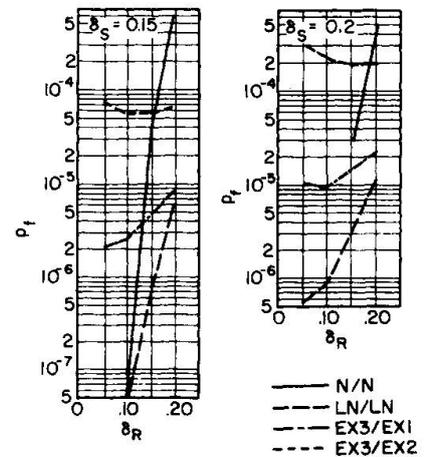
FIG. 2 INFLUENCE OF DISTRIBUTION FUNCTIONS ON PROBABILITIES OF FAILURE
