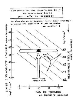
La dispersion de la résistance réelle avant torsadage provoque une dispersion du pas de torsion qui stabilise la limite d'élasticité obtenue par torsadage.
