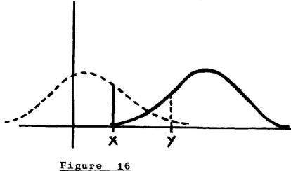
La figure 16 montre que pour une classe d'acier connue ou une fabrication bien définie (courbe pleine), le choix d'un niveau X suffit en contrôle courant, mais qu'il peut être nécessaire, tant qu'un histogramme représentatif d'une telle classe n'est pas connu, de contrôler à un niveau Y supérieur pour exclure les résultats issus d'une population inférieure.
