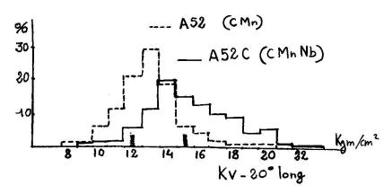
La figure 18 donne les distributions relatives à Kv long - 20 sur deux lots : l'un de 2500<sup>T</sup> en acier au C - Mn normalisé e 8 à 28 ; l'autre de 1500 T. en acier calmé au Niobium normalisé e 12 à 30
