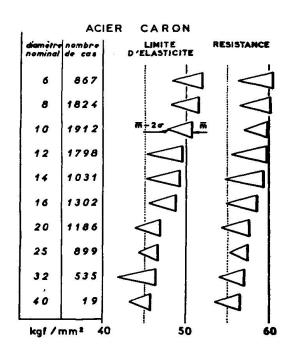
La figure 20 donne pour les diamètres 6 à 40 d'acier du type Caron (acier semi-calmé, laminé en carré puis torsadé avec un pas de 10 diamètres environ) une idée de l'influence du diamètre.
