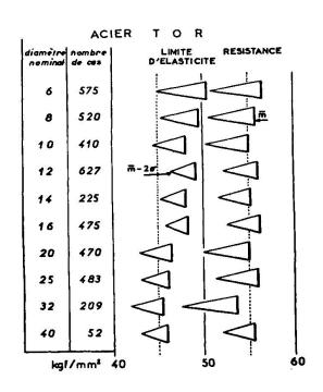
Il s'agit ici d'acier Tor, les petits diamètres  $\emptyset \le 10$  comportent des nervures, les diamètres supérieurs des nervures et verrous
