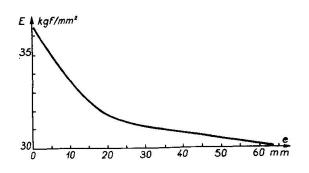
d'élasticité E en travers qu'avec une précision de ± 3 si l'on tient compte du fait qu'elle a été établie en ne considérant que les seuls éléments Carbone et Manganèse, toutes épaisseurs de tôles étant confondues dans le domaine 10 à 40 mm. (La figure 11 donne une idée de la variation de E travers en fonction de l'épaisseur).
