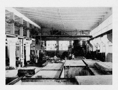
Bild 11 - Produktionshalle zur Herstellung von Deckenelementen mit Hohlraum (Technologie nach Abschnitt 3.3) im Vordegrund: Dampfgruben links im Hintergrund: Elektrothermische Vorspannanlage rechts im Hintergrund: Mischanlage und Kernrohrgerät zur Herstellung der Hohlräume.
