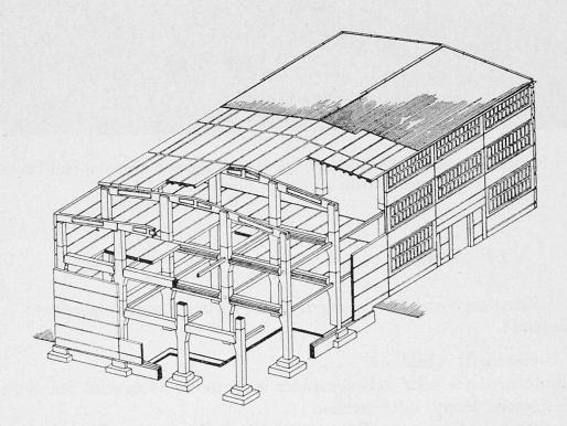
Bild 6 - Isometrische Darstellung zum Typenprojekt eines Geschossbaues in Skelettbauweise (Rahmenkonstruktion) mit 1000 bis 2500 kp/m² Nutzlast (max. Masse der Einzelemente 5000 kg).
