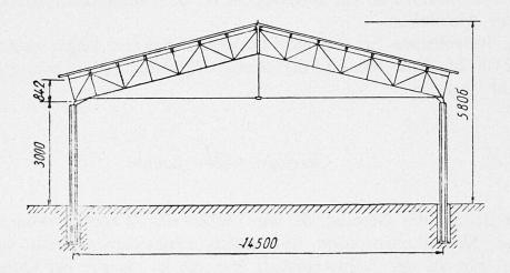
Bild 4 - Schema für ein landwirtschaftliches Produktionsgebäude in Mastenbauweise mit Stahlleichtbinder. Die beiderseitigen Stützen (Masten) sind im Erdboden eingespannt.
