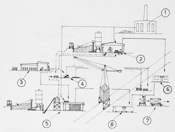
Bild 13 - Produktionsablaufschema für ein Betonwerk, das auf die komplette Herstellung von Gebäuden spezialisiert ist (mehrere Technologien nach Abschnitt 3.1.1 bis 3.1.3):
