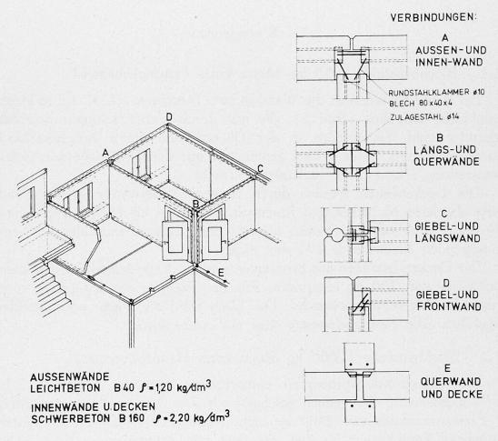
Bild 3 - Kostruktionsprinzip der Plattenbauweise (max. Masse der Baulemente 5000 kg) kräftige gestrichelte Linien in der isometrischen Darstellung stellen die Lage der Bewehrung der Wandelemente dar. Weitere Bewehrungen - ausser zwei Transporstählen - sind nicht vorhanden.
