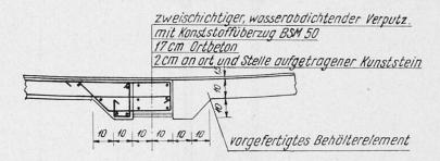
Bild 5 - Verbindung der Fertigteile.
