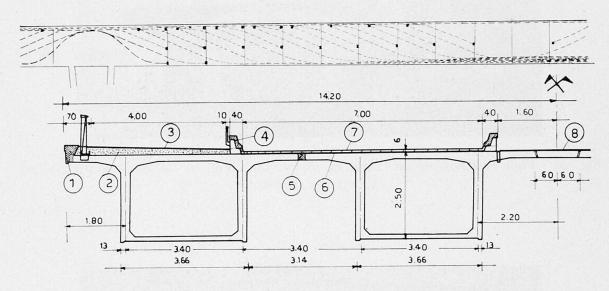
Fig. 28 - Pont à voussoirs de Choisy-le-Roy. En haut = plan de couffrage. En bas = coupe transversale type: 1, Corniche préfabriquée en b. a. - 2, Béton de forme - 3, Revêtement d'asphalte - 4, Bordure glissière préfabriquée - 5, Joint coulé sur place - 6, Revêtement bitumineux - 7, Chape d'asphalte - 8, Dalle de raccordement entre les 2
