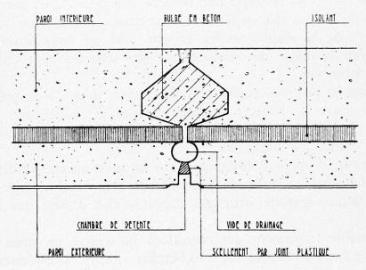
Fig. 9 - Disposition d'un joint de façade.
