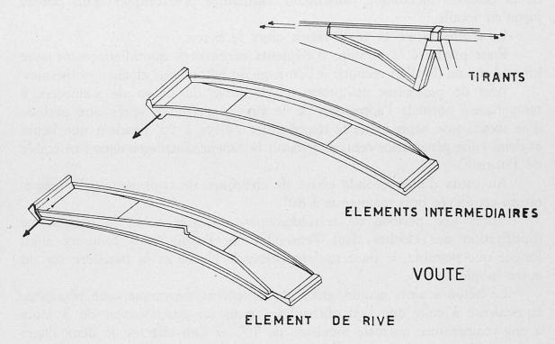
Fig. 16 - Eléments de couverture.
