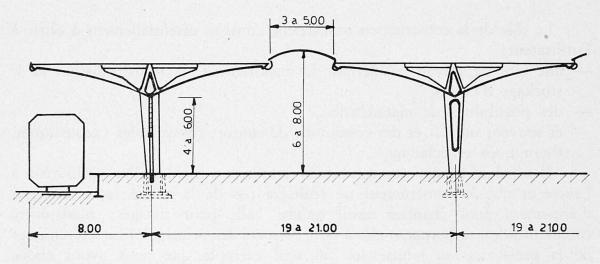
Fig. 13 - Halle d'usine, coupe transversale (Boussiron).
