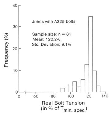
Fig. 7. Initial Bolt Preload: 1/2 Turnof-Nut Installation
