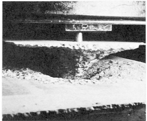
Bild 8 Bruchbild bei Betonausbruch
