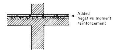
Fig. 9: Slab Overlay
