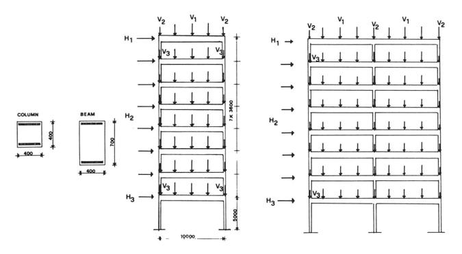
Fig. 18 - Multistorey frame; example1
