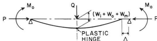
a) PIN- ENDS BEAM- COLUMN
