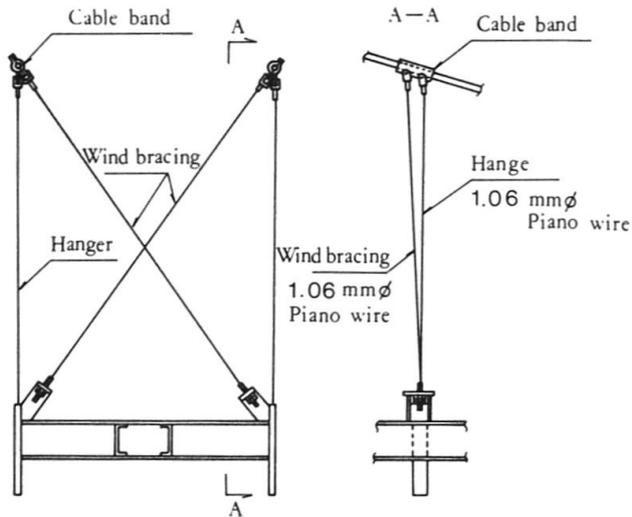
Fig. 6. Wind bracing
