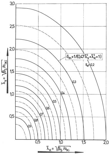
Bild 8 Interaktion zwischen Stabknicken und Plattenbeulen nach Herzog [1]
