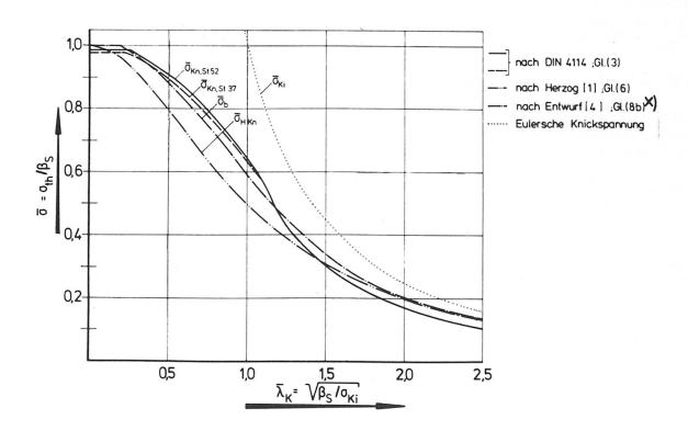
Bild 5 Zusammenstellung der rechnerischen Tragknickspannungen x) entspricht der Traglastkurve b der EKS [5]
