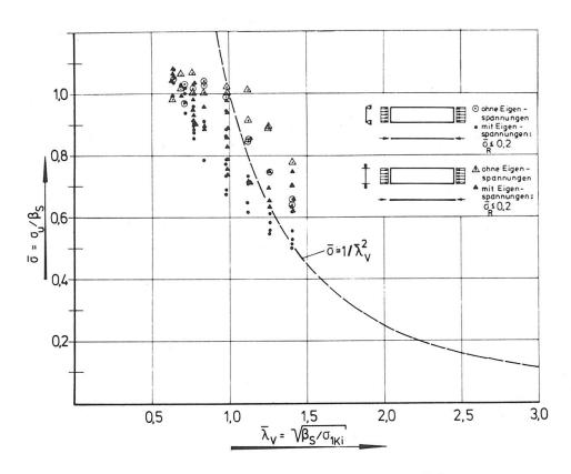
Bild 1 Traglastversuche an Platten nach Moxham [6]
