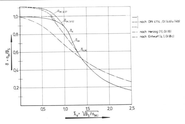
Bild 6 Zusammenstellung der rechnerischen Tragbeulspannung
