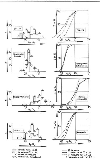
Bild 10 Auswertung von 87 Traglastversuchen an dünnwandigen Kastenstützen
