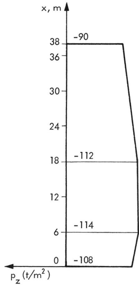
FIGURE 9 DISTRIBUTION OF RADIAL LOAD ON CELL WALLS
