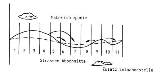
Figur 1. Massenverteilung in einem typischen Profil
