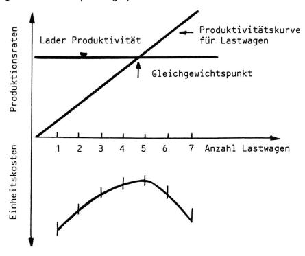
Figur 4. Produktivitäts- und Kostenkurven für ein deterministisches System
