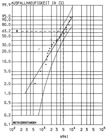
Bild 4 Ausfallhäufigkeitsfunktion für den Lenkachsbolzen
