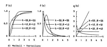
Bild 2 Verteilungsfunktion, Dichte und Ausfallrate von Lebensdauerverteilungen
