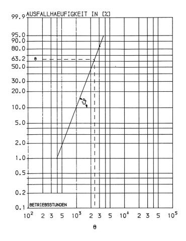
Bild 3 Weibull-Wahrscheinlichkeitsnetz mit einer Ausfallhäufigkeitsfunktion
