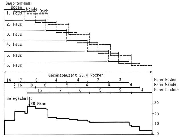
Fig. 5b Variante B, 1. Lösung: Taktprogramm, 3 Equipen (je 1 für Böden, Wände, Dächer)
