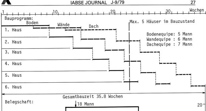
Fig. 5c Variante B, 2. Lösung: Lernprogramm, 3 Equipen
