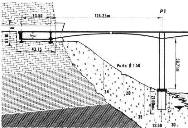
Fig. 2 Nantua, Culée Ouest en tunnel
