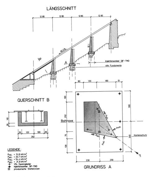
Bild 2 Projektierter lawinensicherer Brückenneubau
