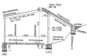
Abb. 3 Lawinengalerie Sträätli Querschnitt bei Ausweichstelle
