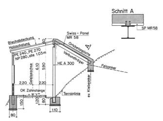
Abb. 2 Lawinengalerie Sträätli Normalquerschnitt
