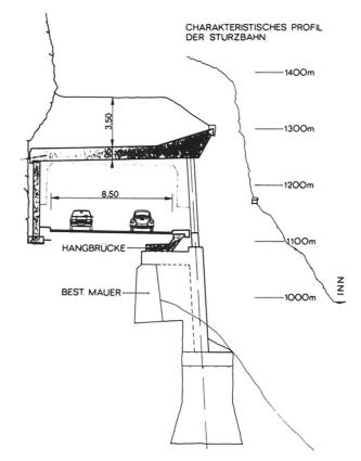
Bild 1 Querschnitt Steinschlaggalerie
