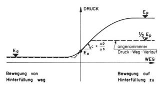
Fig. 3 Schematisches Erddruck-Weg-Diagramm
