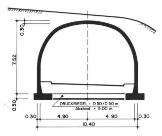
Fig.1 Querprofil mit Gewölbequerschnitt
