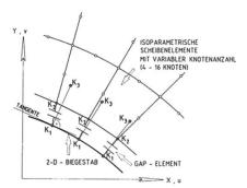
Bild 2 Verbindungselement GAP
