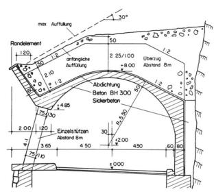
Bild 1 Galeriequerschnitt
