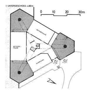
Fig. 3 Sockelgeschoss –1 mit Betriebs- und Büroräumen. Gerasterte Flächen = drei Einzelfundamente à je 225 m²
