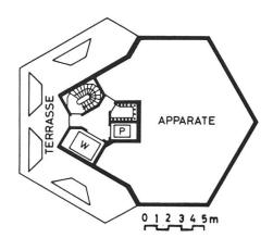
Fig. 2 Ausbauten auf 118 m mit asymmetrisch angehängtem Apparateraum und Stahlterrasse mit Richtstrahlantennen
